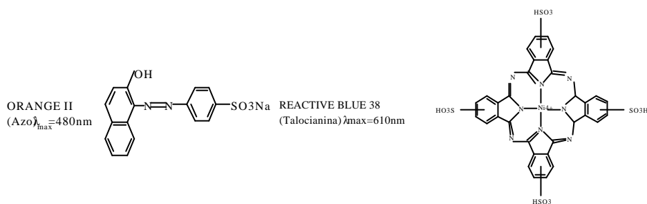
Figura 10. Estructura do Orange II (tinte tipo azo) e do Reactive Blue 38 (tinte tipo talocianina)
