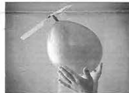
El principio de acción/reacción, mostrado con este sencillo experimento: un globo lleno de aire al ser vaciado produce el movimiento de las aspas.
