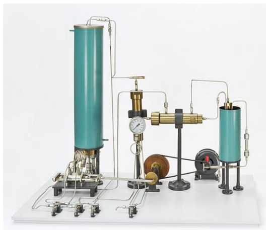
O deseño experimental de Haber e Le Rossignol para a obtención de amoníaco (Deutsches Museum)
