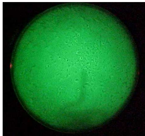
Ilustración 4: Iluminación con la cruz de Malta abatida. Se aprecia la sombra del soporte de la cruz.
