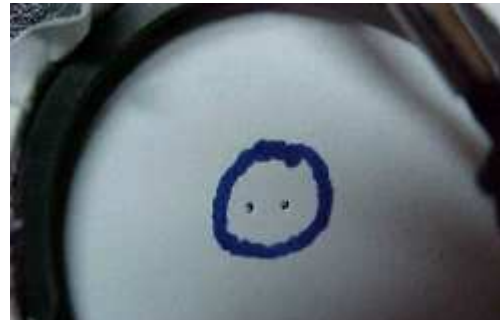
Ilustración 1: Pantalla de difracción montada sobre un soporte de lente
